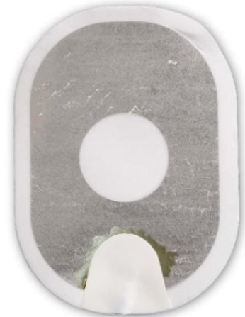
Abbildung 3: Gel fast vollständig von Folie abgelöst.
